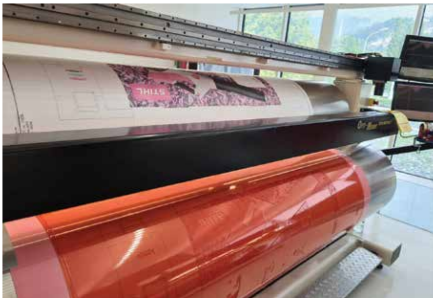
Der Schaumunterbau mit Vliesrückseite erleichtert das Positionieren der großformatigen Post-Print Montage auch in der Andruckmaschine.
