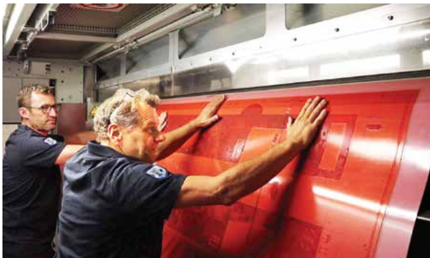
Die Kolb Spezialisten Thomas Eggart und Wolfgang Prinz beim Rüsten der Großformat-Montagen am Druckwerk. Deutlich zu sehen ist die Schneidelinie im gestoßenen Plattensatz.
