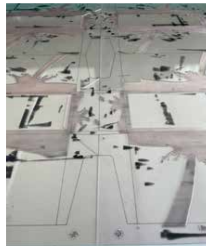
Gestoßene Druckplatten Montage mit den Markierungslinien des Plotters.
